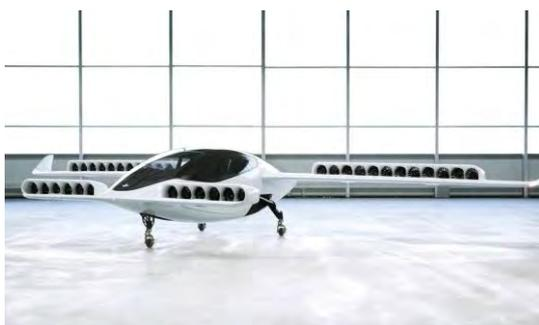
*A aeronave da Lilium tem 36 motores, com autonomia de 250 km e velocidade máxima de 300 km/h Foto: HANDOUT / REUTERS*
