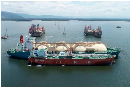
Pela 1ª vez, o Porto de Itaguaí realizou uma operação de transferência de gás natural liquefeito (GNL). O objetivo era o reabastecimento da Unidade Flutuante de Armazenamento e Regaseificação (FSRU) da Karmol LNGT ASIA, afretada pela Karpowership Brasil (KPS), que está ancorada na Baía de Sepetiba. A transferência do GNL do navio para o FSRU decorreu entre os dias 25 e 26 de outubro.
